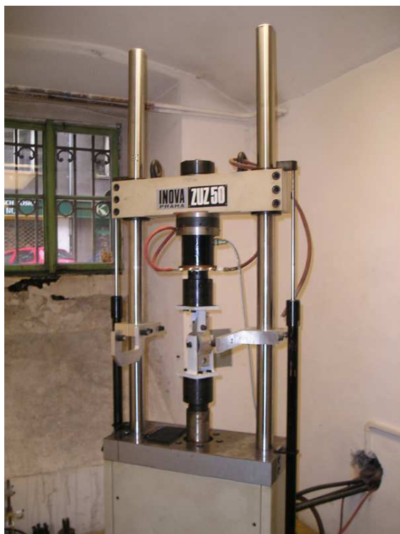
Obrázek 5.4: Univerzální zkušební stroj ZUZ 50 s upnutým vzorkem
