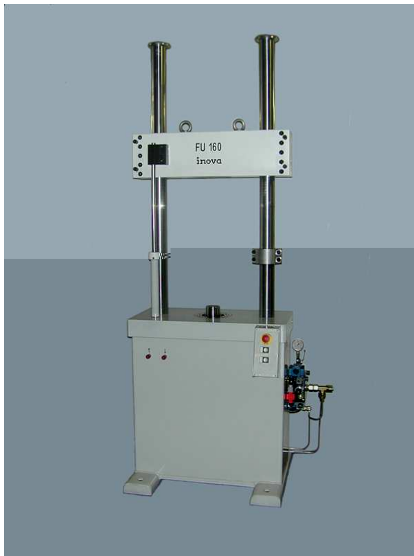
Obrázek 2.1: Univerzální testovací stroj, Inova FU 160
