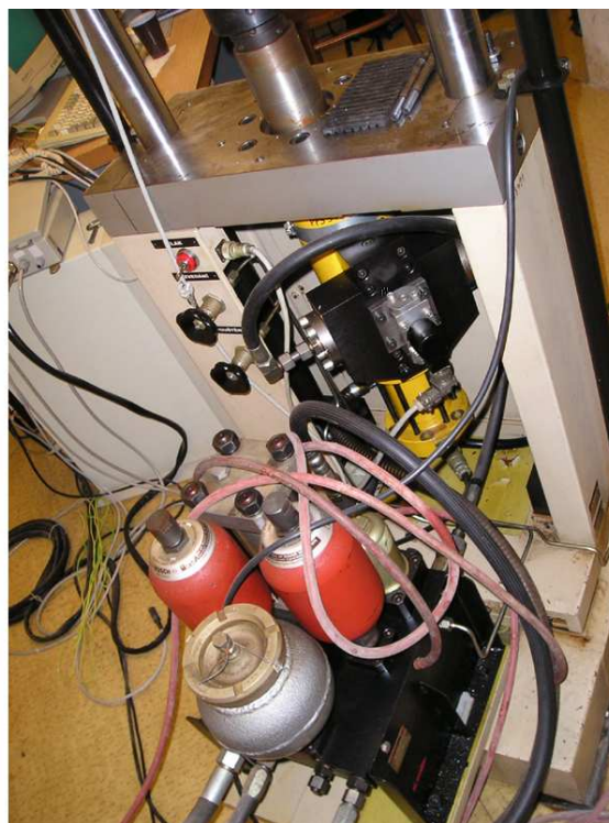
Obrázek 5.4: Univerzální zkušební stroj ZUZ 50 s upnutým vzorkem
