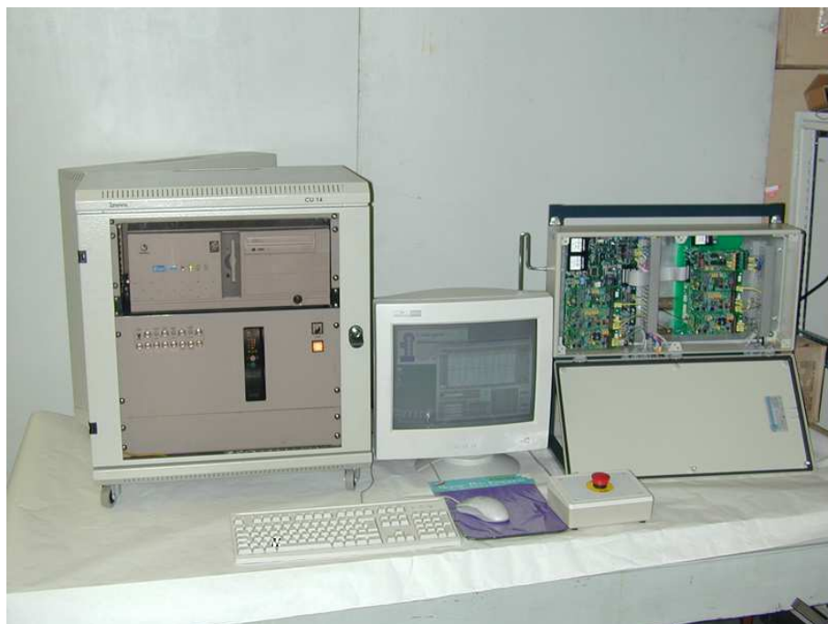
Obrázek 5.2: Řídicí systém - řídicí počítač Inova (vlevo), regulátor Inova (vpravo)
