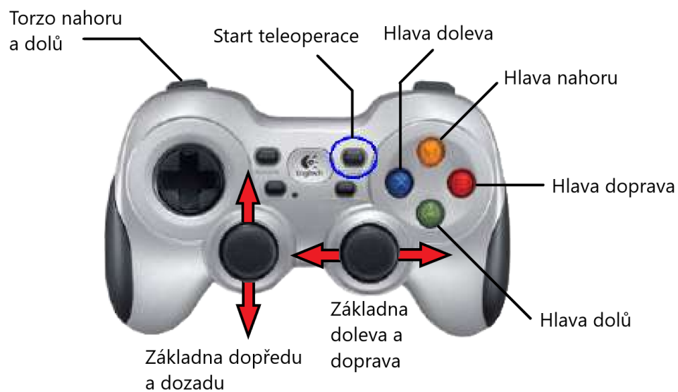
Obrázek 4.3: Ovládací schéma ovladače pro teleoperaci robota.
