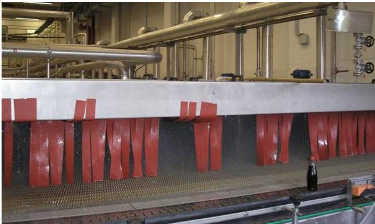
Obrázek 3.4: Výstup tunelového pasteru
