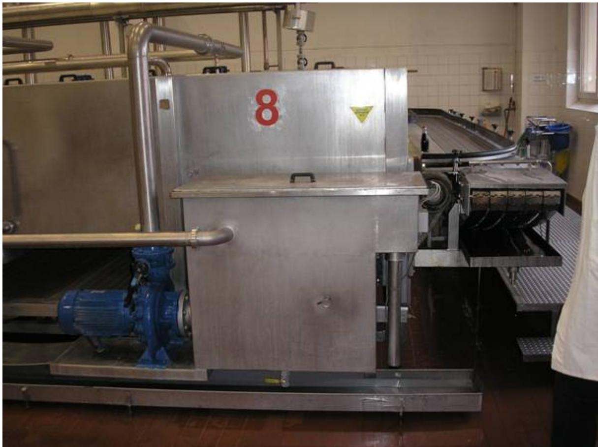
Obrázek 3.2: Příčný dopravník na výstupu pasteru
