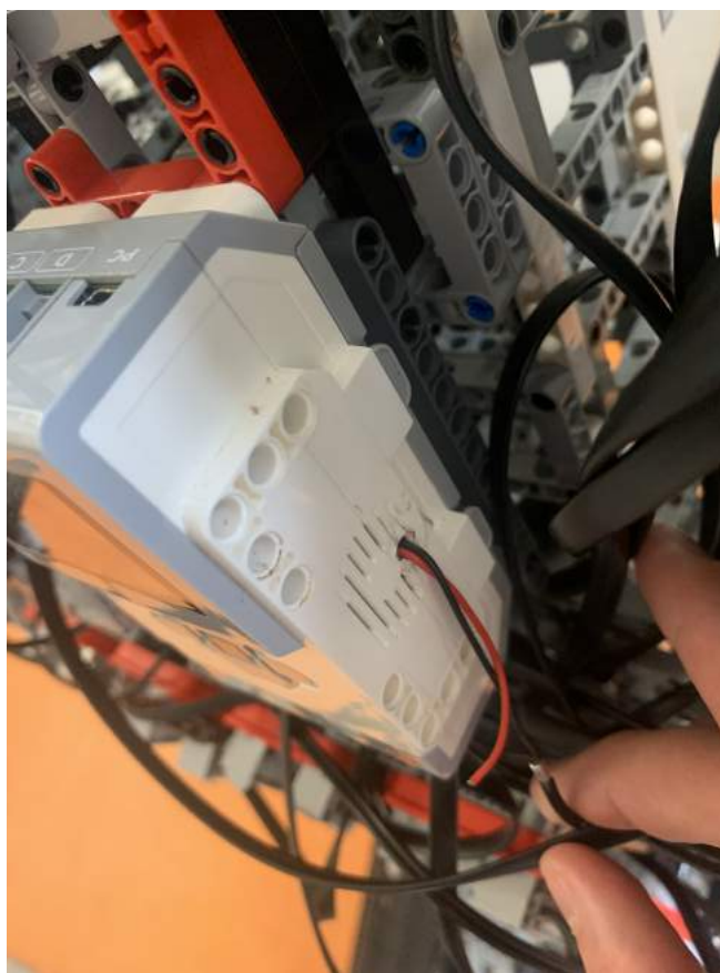
Obrázek 3.24: Zapojení audio portu
