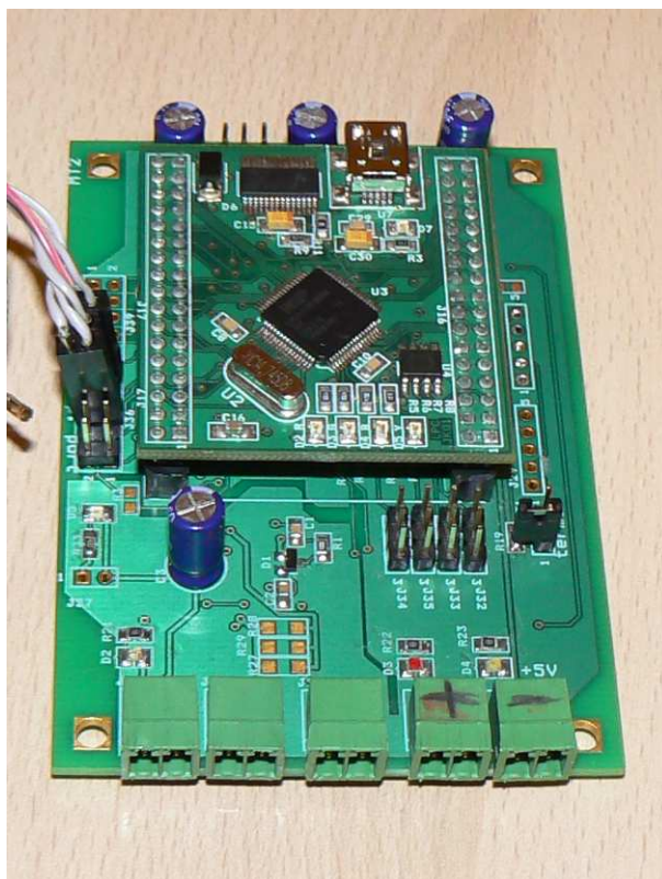
Obrázok 3.12: Doska LPC2119 s rozširujúcou doskou ebBoard.
