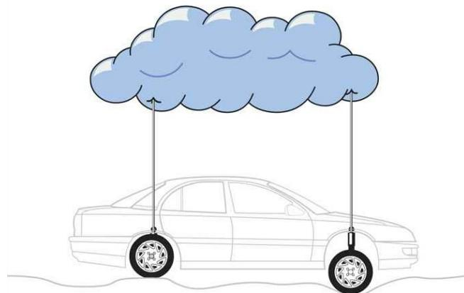
Obrázek 1.1: Ideální zavěšení vozidla – „sky-hook“
