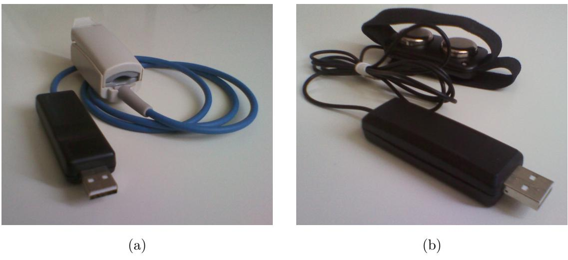
Obrázek 3.3: Použité senzory: (a) Puzní oxymetr. (b) Senzor GSR
