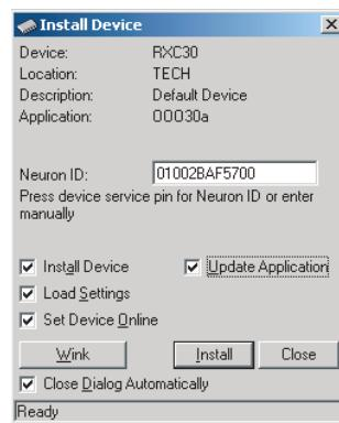
Obrázek 5.16: Instalace modulu DESIGO RX v nástroji RXT
