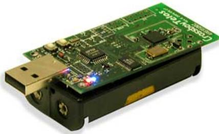
Obrázek 2.1: Senzor telosb od firmy Crossbow včetně pouzdra pro baterie
