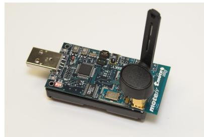
Obrázek 3.8: Senzor tmote Sky s přídavnou anténou
