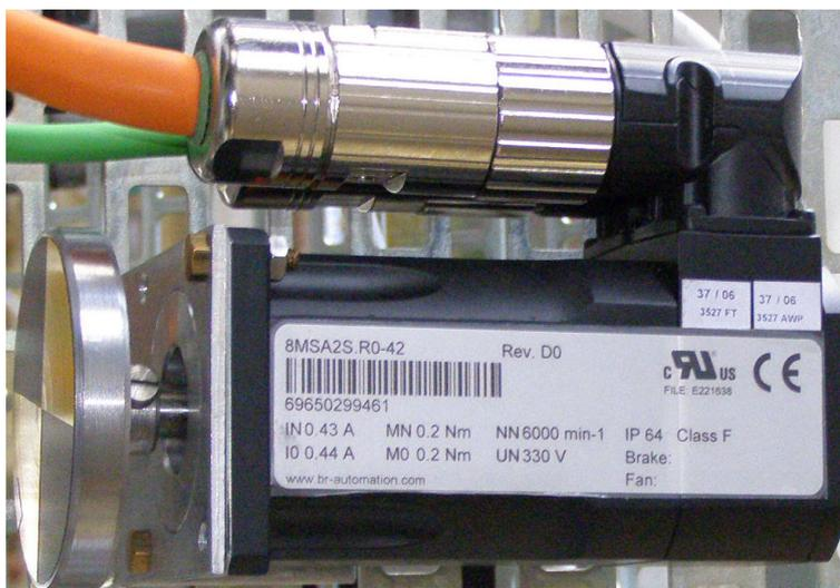
Obrázok 3.6: Servomotor 8MSA2S.R0
