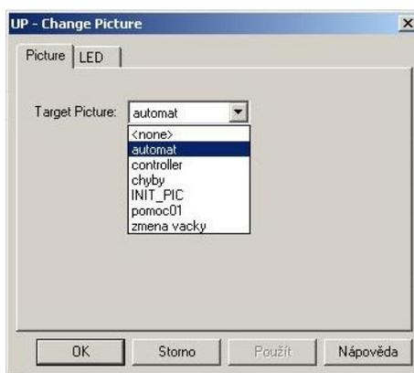
Obrázok A.46: Nabídka obrazovok funkčního tlačítka s funkcí "Změna obrazovky"
