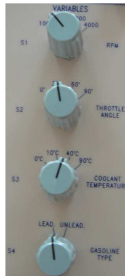
Obrázek 3.3: Spínače pre prepínanie vstupných parametrov
