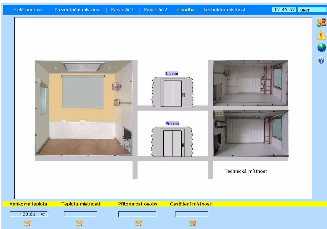
Obrázek B6 – Navržená vizualizace – předpřipravená obrazovka pro ovládání Výtahu na chodbě
