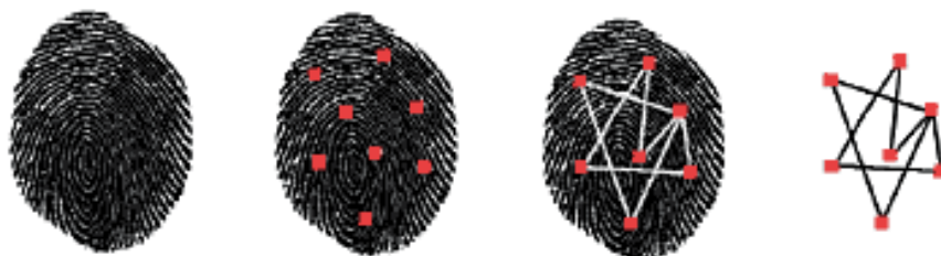
Obrázek 5 – Znáznornění postupu vytvoření template otisku
