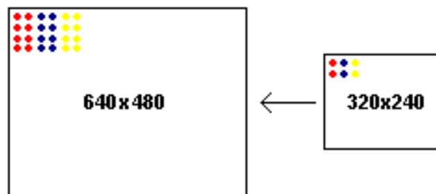
Obrázek 5.2: Zobrazování pixelu kamery na monitoru
