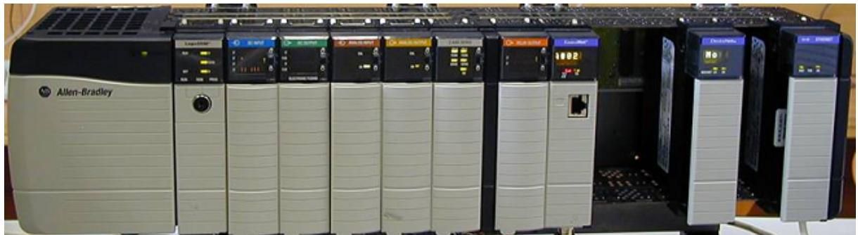
Obrázek 1.1: PLC firmy Allen-Bradley se zabudovaným „PID regulátorem“
