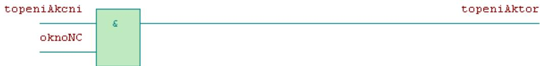
Obrázek 4.7: Ovládání topení v jazyce funkčních bloků
