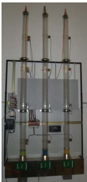
Obrázek 1: Model pneumatických výtahů
