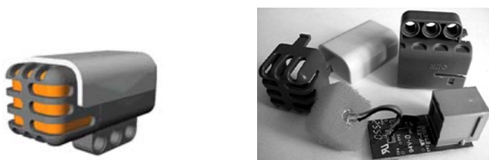
Obr. 2.20: Zvukový senzor a jeho detail
