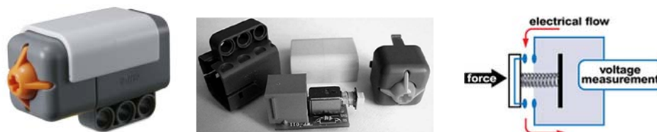
Obr. 2.21: Dotykový senzor a jeho detail
