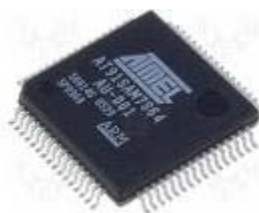
Obr. 2.8: procesor Atmel ARM7
