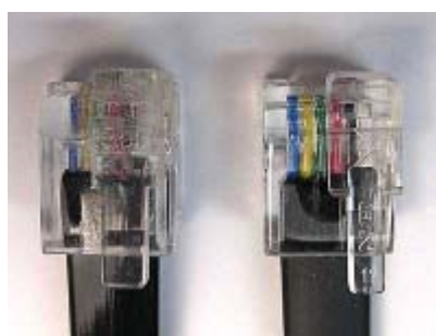
Obr. 2.14: Propojovací kabely RJ-12 pro NXT
