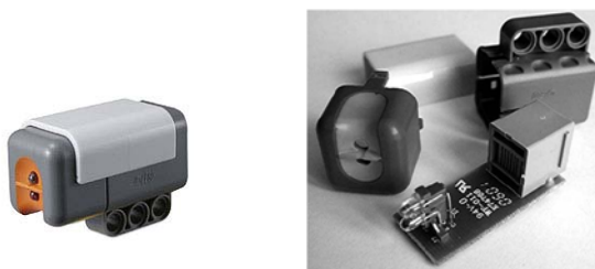
Obr. 2.17: Světelný senzor a jeho detaily
