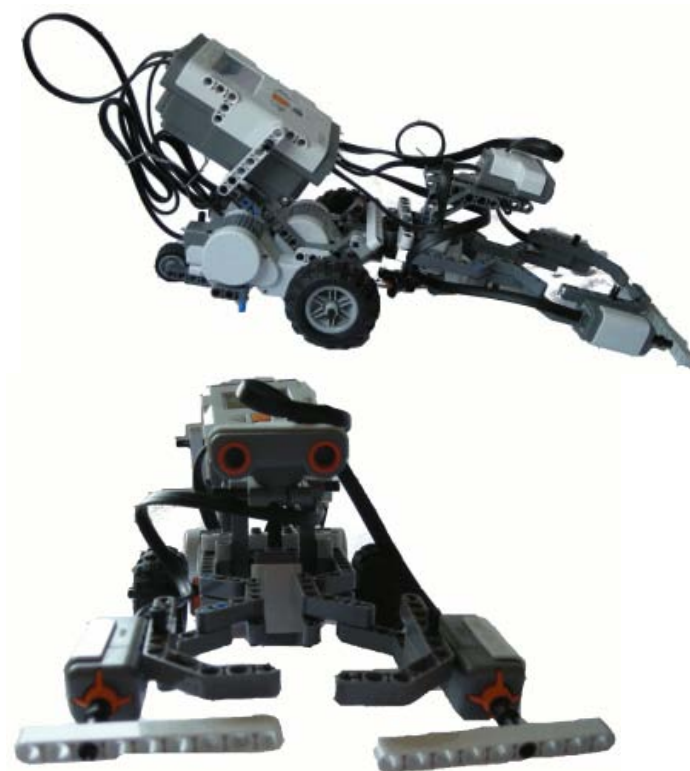
Obr. 4.8: konstrukce robota pro úlohu "překážky". Pohled z boku a zepředu
