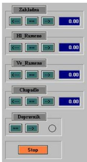
Obr. 4.11 Část ovládacího panelu pro manuální režim v prostředí Reliance
