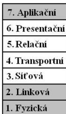
Obr. 3.3 Síťový model OSI
