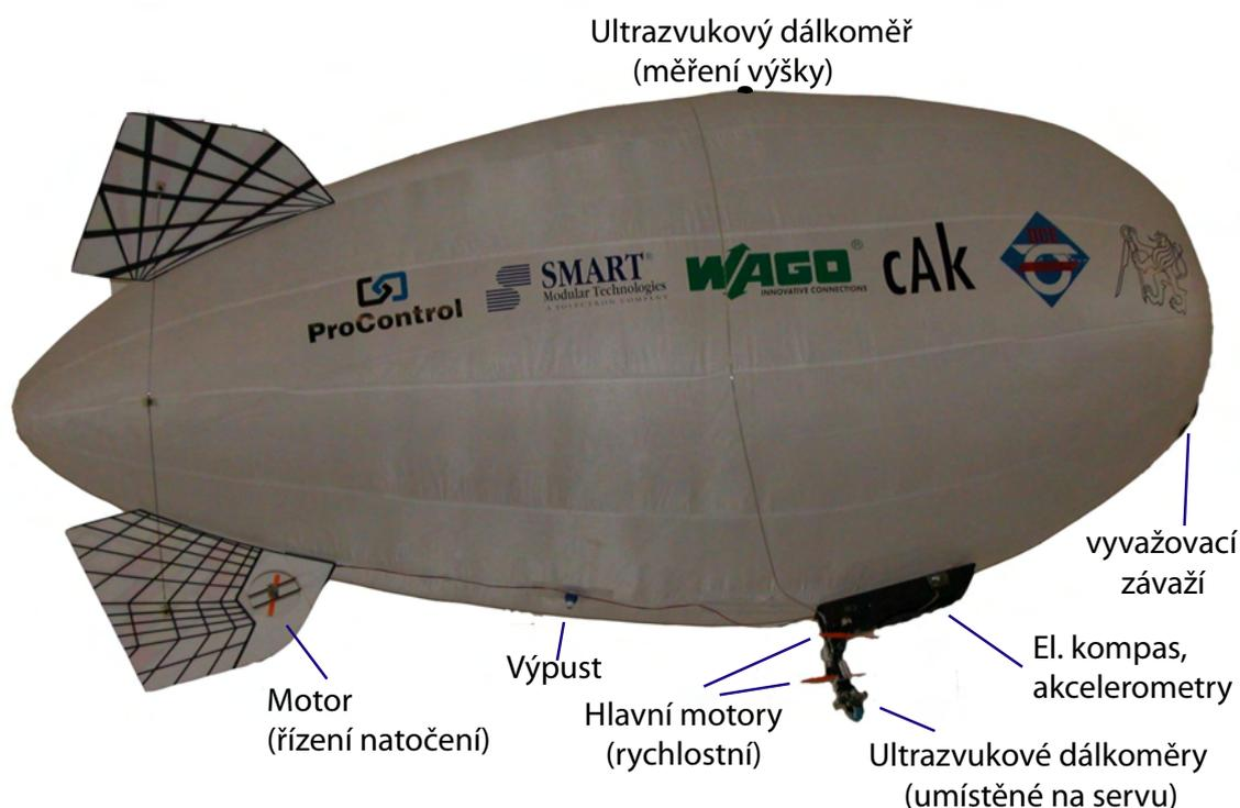
Obrázek 2.1: Model, umístění akčních členů a senzorů
