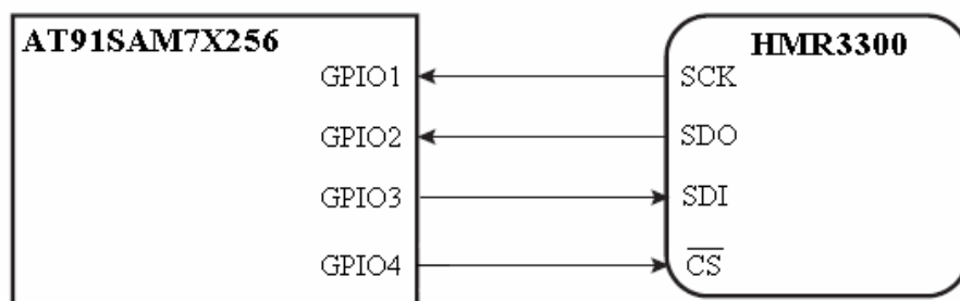
Obr. 4.3 – Zapojení magnetometru při softwarovém řešení komunikace
