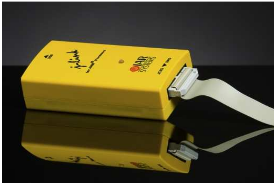
Obr. A.7 – J-Link od IAR System – JTAG debugger pro procesory ARM [27]
