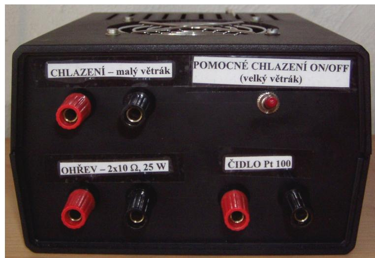
Obrázek 2.7: Přední panel tepelné soustavy
