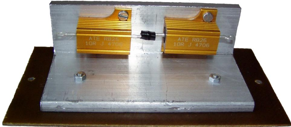
Obrázek 2.1: Topné rezistory připevněné na hliníkovém bločku
