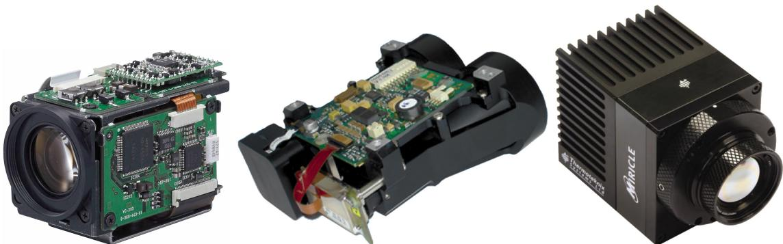
Obrázek 1.2. Vlevo: optická kamera, uprostřed: laserový dálkoměr, vpravo: infra kamera
