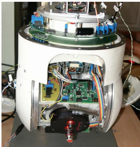
Obrázek 5.2. Elektronika vnitřního závěsu základny. Na obrázku můžete vidět dva ploché vícežilové barevné kably, které připojují k desce SPIboard gyroskopy.
