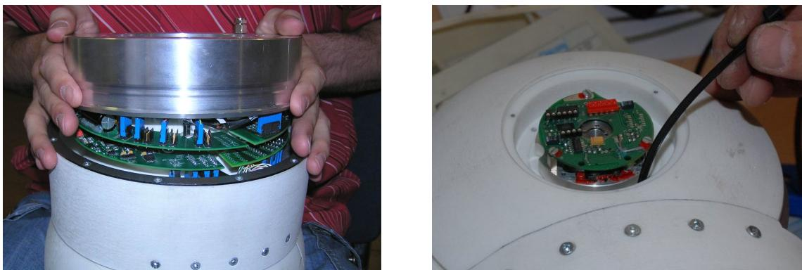
Obrázek 2.7. Vlevo místo pro umístění elektroniky řídicích jednotek přístupné po odstranění hliníkového krytu v horní části základny. Vpravo optický inkrementální snímač elevačního kloubu umístěný na opačné straně než je motor a místo pro průchod kabelů.
