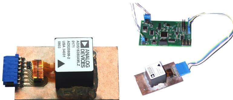
Obrázek 4.9. Vlevo deska s kombinovaným tříosým gyroskopem/akcelerometrem ADIS 16350. Vpravo propojení s deskou SPIBoard.
