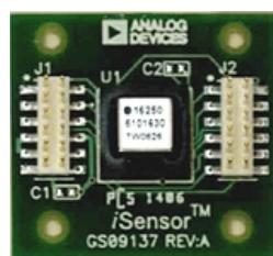
Obrázek 3.9: Vývojová destička s gyroskopem od Analog Devices
