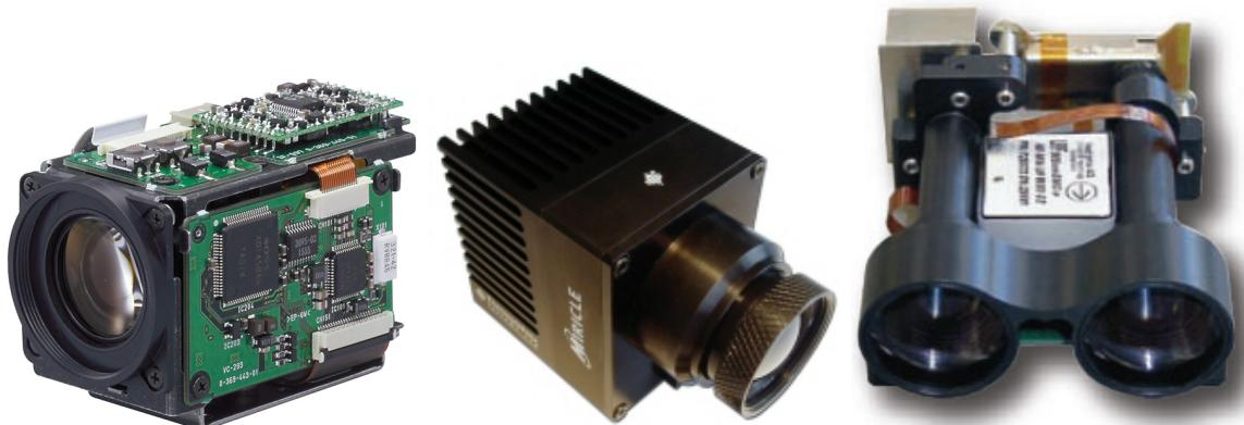
Obrázek 3.5: RGB kamera, IR kamera (s odlišnou optikou), laserový dálkoměr
