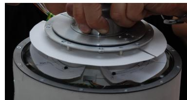
Obrázek 2.5: Detail místa pro umístění PCB (Desky jsou nahrazeny papírovými díly)
