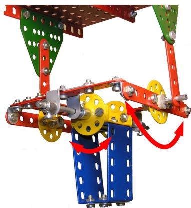
Obrázek 2.2: Model konstrukce typu tip-tilt
