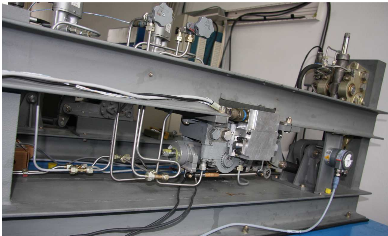
obr. 8.3– Hydraulické zkušební zařízení dvoukanálového servomechanismu EHSA
