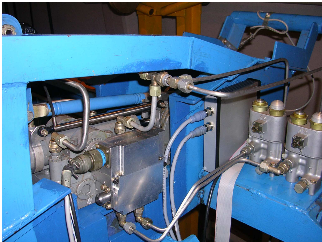
obr. 12.9 – Alternativní umístění a propojení ECU 1 a EHSA
