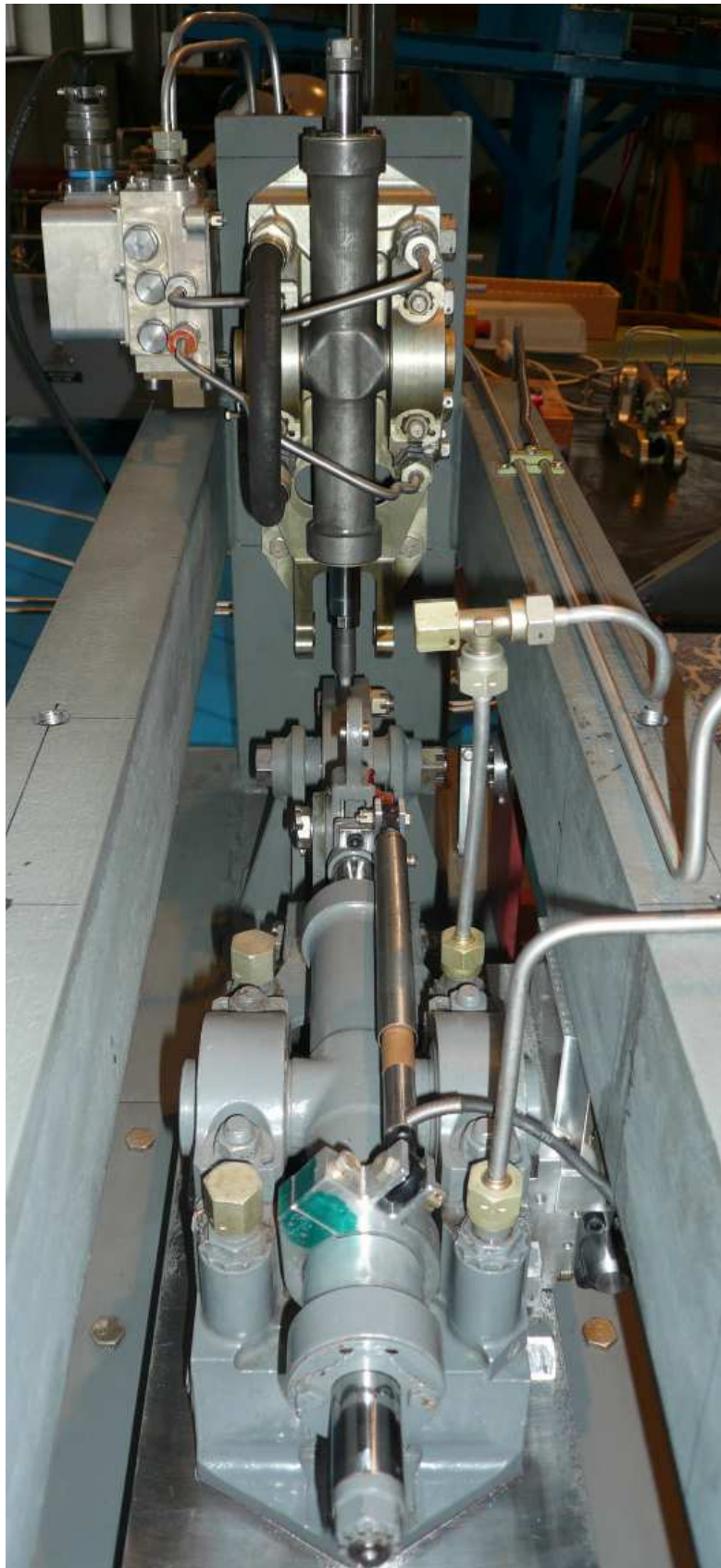
obr. 12.13 – Vrchní pohled na zatěžovací zařízení, umístění EHA a zatěžovacího systému
