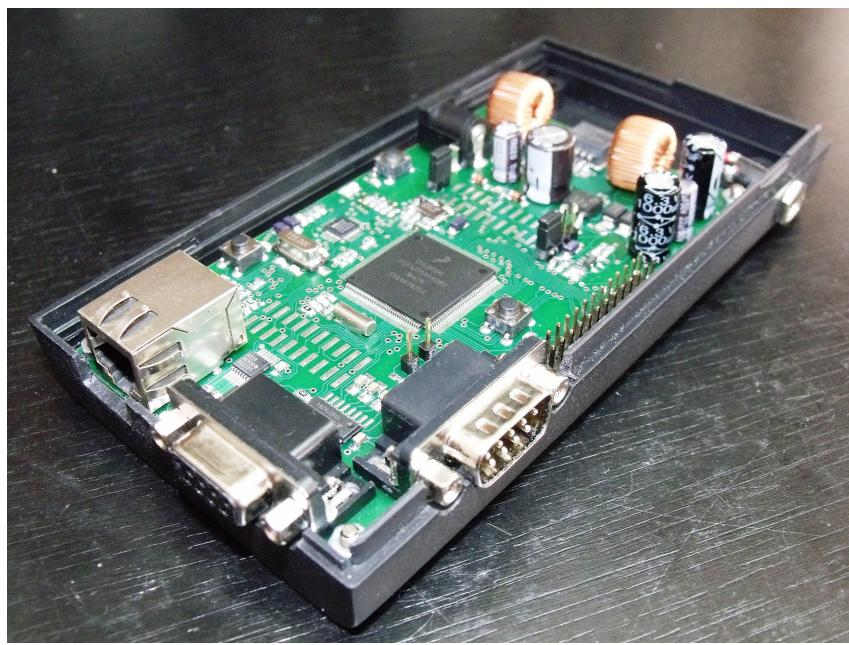
Obrázek 2.7: Osazená deska plošného spoje
