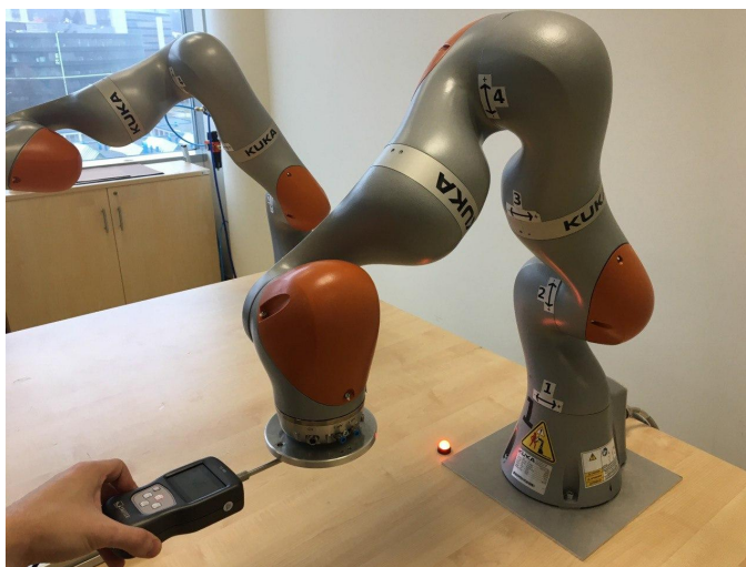
Fotka 6.1: Poloha robotu během experimentů s kloubovými souřadnicemi \vec{q} = [0^\circ, 30^\circ, 0^\circ, -100^\circ, 0^\circ, 50^\circ, 0^\circ]^T . Používání siloměru Sauter FC 500 během experimentů.
