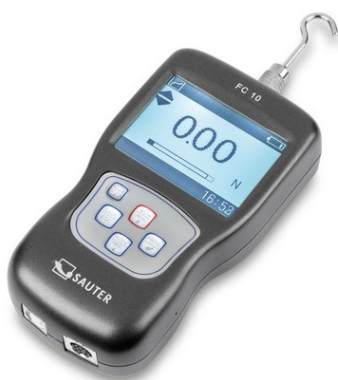
Fotka 3.7: Siloměr Sauter FC 500. Maximální rozsah měřené síly siloměru je \pm 500 N. Přesnost siloměru je \pm 0.2\% z maximálního rozsahu. Rozlišení siloměru je 0.1 N. Vnitřní vyčítací frekvence siloměru je 1000 Hz. Ze siloměru je možné vyčítat data do ROSu přes USB [24].
