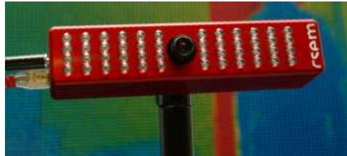
**Obr. 3.27: Miniaturní 3D TOF kamera SR-2 s možností připojení USB 2.0**
