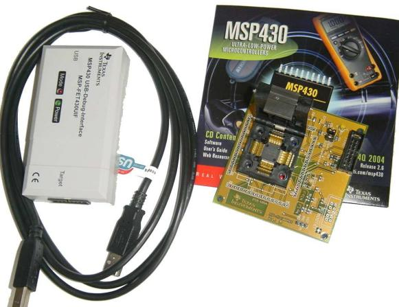
Obr. 5.45: Development kit pro mikroprocesory řady MSP430
