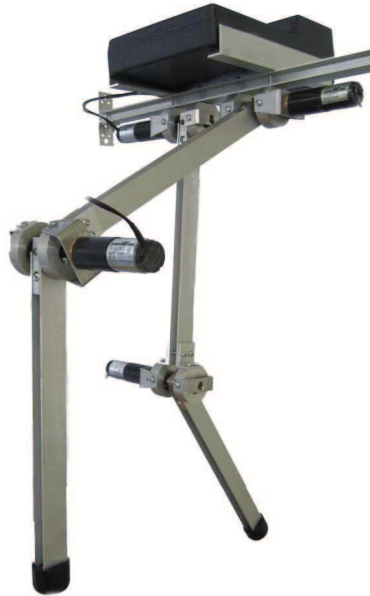
Obrázek 2.1: Mechanický model acrobota
