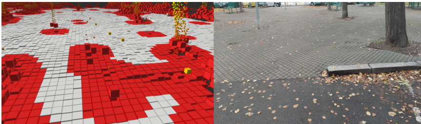
Obrázok 7.3: Klasifikácia obrubníka v reálnych podmienkach - na obrázku je možné pozorovať správne vyhodnotenie priechodnosti obrubníka a jeho okolia. V strede a ľavej strane mapy priechodnosti sa nachádza šum zanesený prechádzajúcou osobou.
