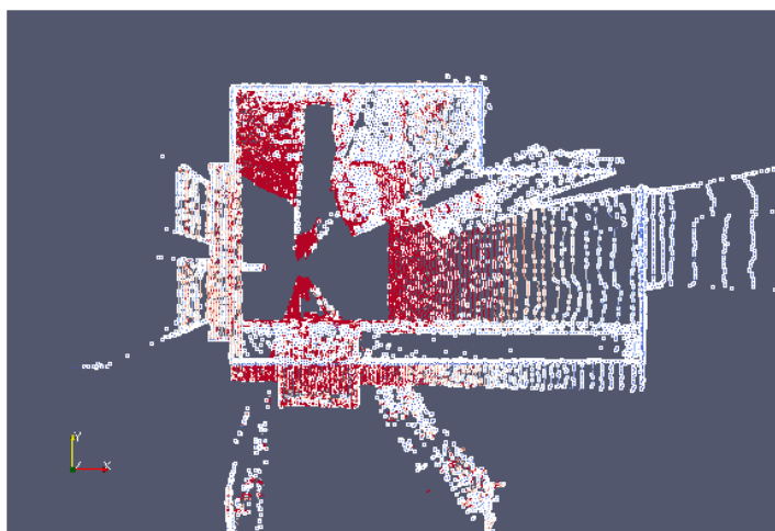
Obrázok 4.5: Aplikovanie filtra MaxDensityDataPointsFilter - pri filtrovaní bola stanovená maximálna hustotou na hodnotu 50000 bodov na m^3 . Červenou farbou je označený pôvodný bodový mrak a bielou farbou je označený bodový mrak po filtrovaní [20].
