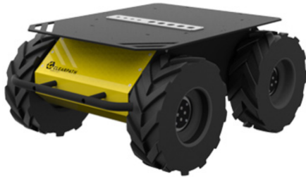
Obrázok 6.1: Robot HUSKY A200 v základnej konfigurácii [38].
