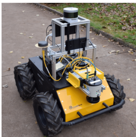
Obrázok 6.3: Konfigurácia HUSKY A200 - na robotovi je umiestnený senzor VLP-16 na platforme a GNSS Trimble BX982 v prednej časti vozidla.
