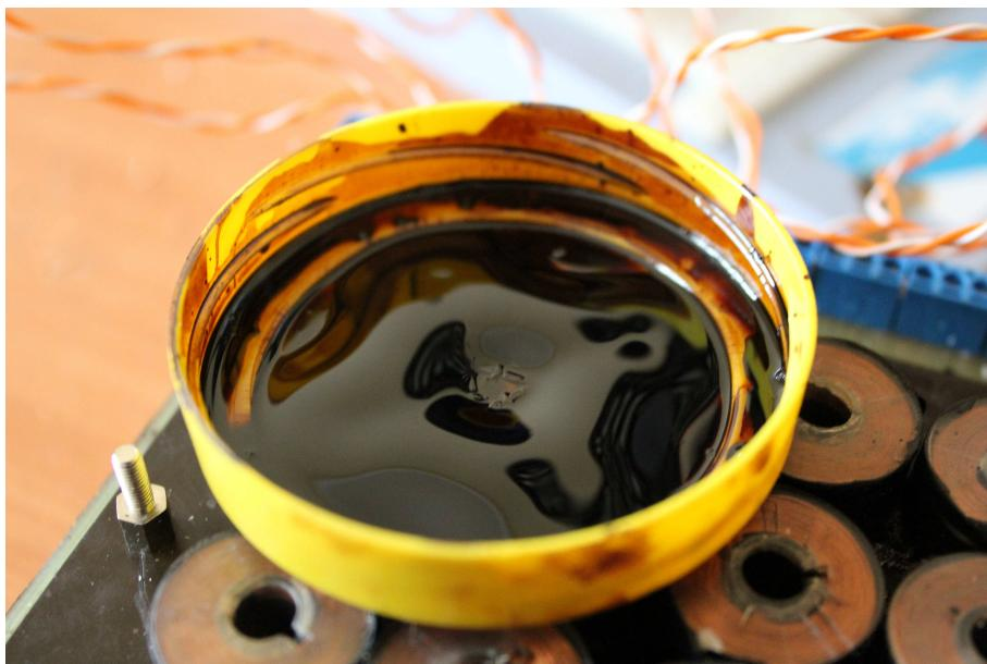
Obrázek 4.13: Magnetické pole generované opačně zapojenými cívkami
