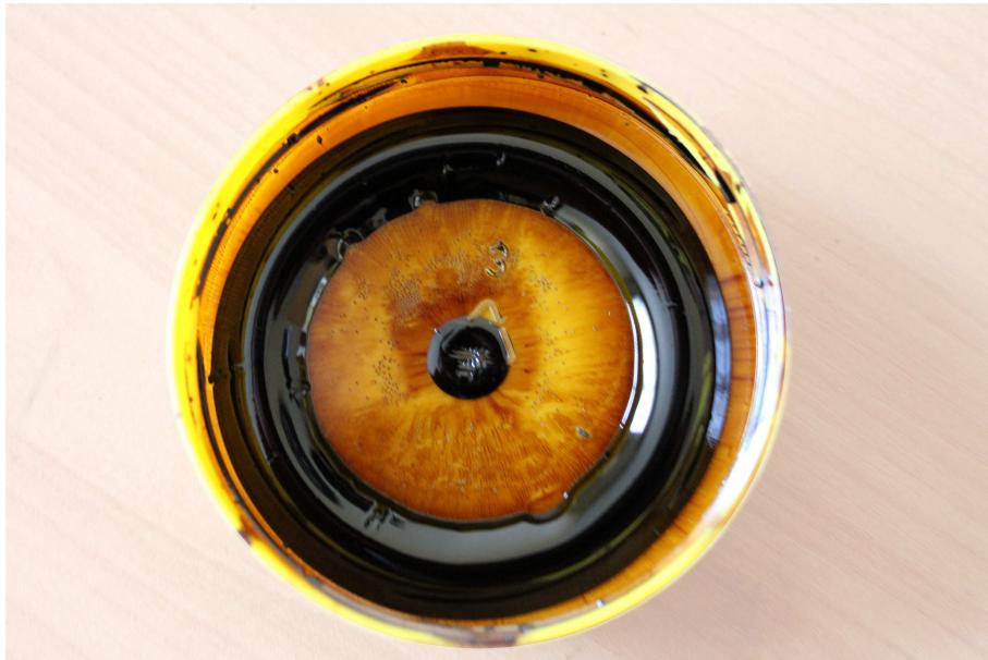
Obrázek 4.17: Magnetické pole generované permanentním magnetem
