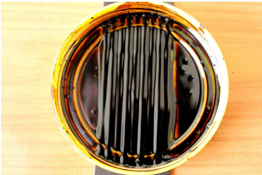
Obrázek 4.18: Magnetické pole tenkého pryžového magnetu
