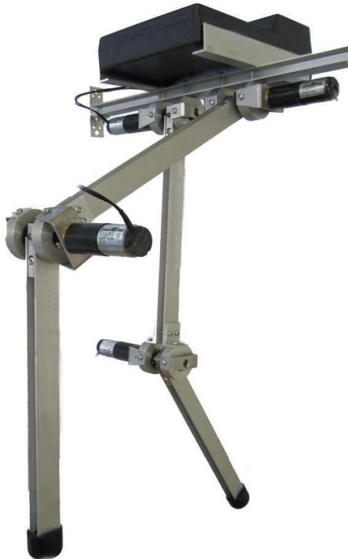
Obrázek 3.1: Fotografie robota bez elektroniky
