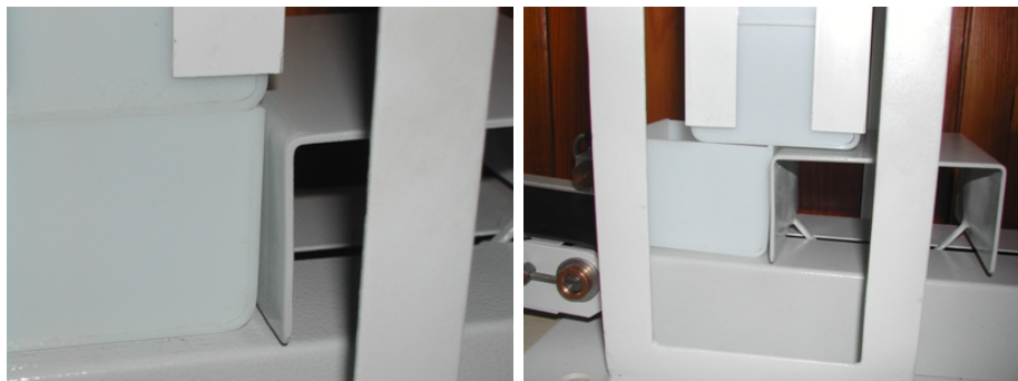
Obrázek 3.2: Zablokování spádu krabiček
