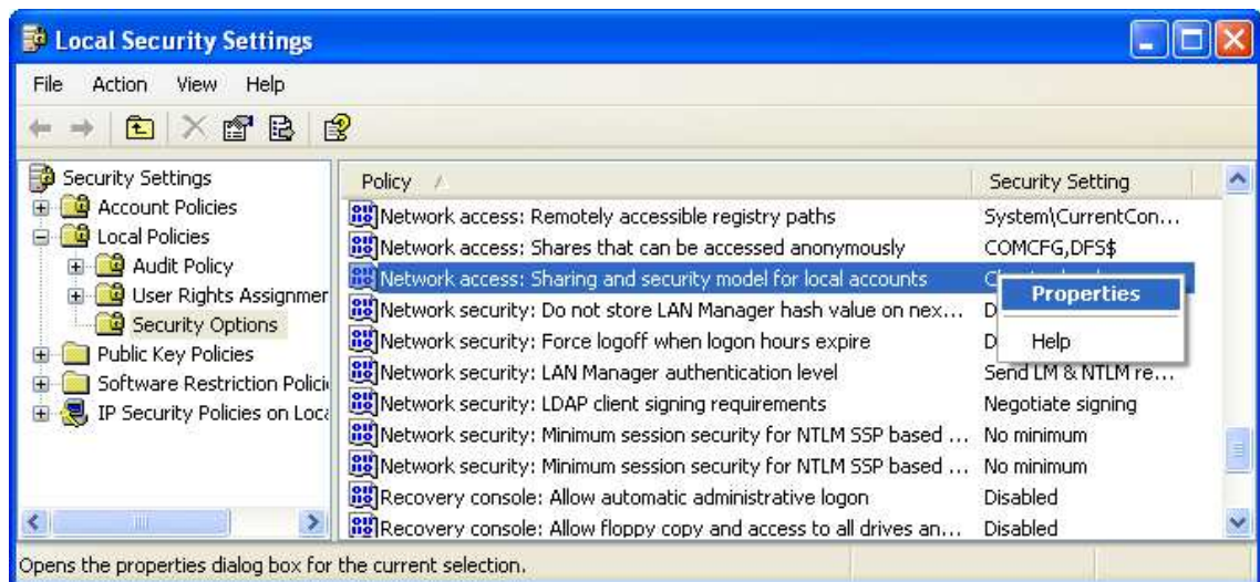
Obrázek 2.3 - Nastavenie OPC bezpečnosti, ktoré povoľuje lokálnym užívateľom overovať sa ako oni sami, čo je bezpečnejšie oproti autentifikovaniu ako host'.
