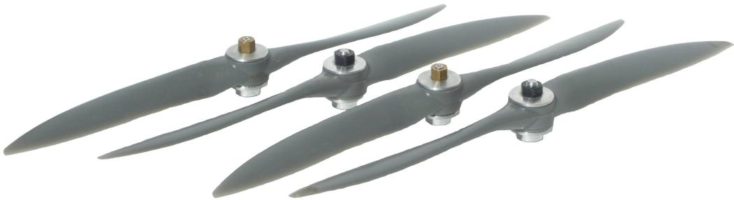
Obrázek 2.7: Vrtule s unašeči (mosazné matice jsou levotočivé, černěné pravotočivé)
