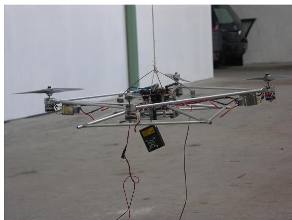
Obrázek D.4: Nabíjení palubních akumulátorů v průběhu letových zkoušek
